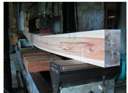
図 3 奈良県産材の強さとスギ梁材 120mm×210mm の曲げ試験
