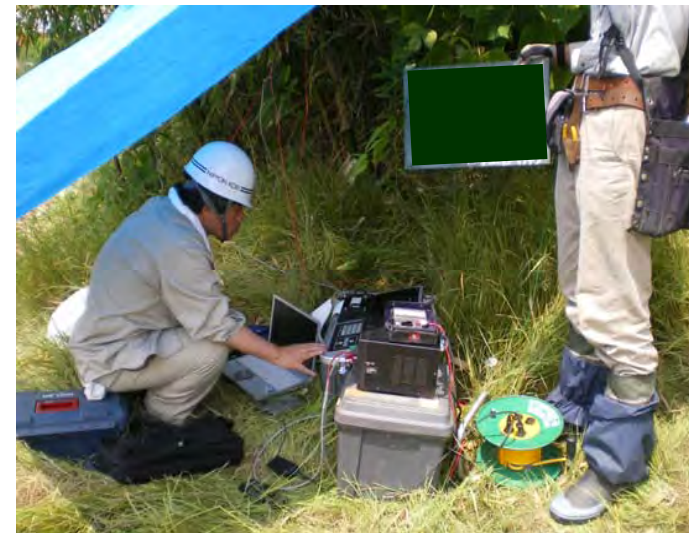
物理探査(電気探査)計測状況の例
