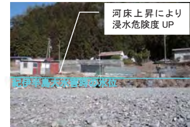
杉清②集落は、河床からの比高が小さく、洪水被害を受けやすい。
