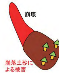
A. 崩土の直撃による被災
